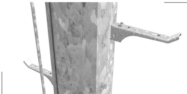
Echelons antidérapants. Ils sont montés clipsés sur le mât, donc démontables. Conformés à la norme NF EN ISO 14122-4
