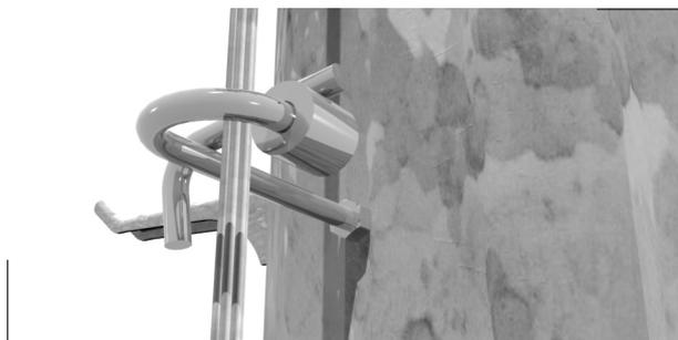
Limiteur de débattement. Il est fixé mécaniquement sur le mât tous les 10m maximum, diminuant ainsi le débattement du câble.
