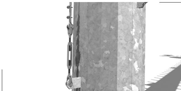
Câble relié au point d'ancrage bas du mât par un ridoir nécessaire à la mise sous tension de celui-ci. Le câble est relié sur le ridoir par une cosse coeur et 4 serre-câbles.
