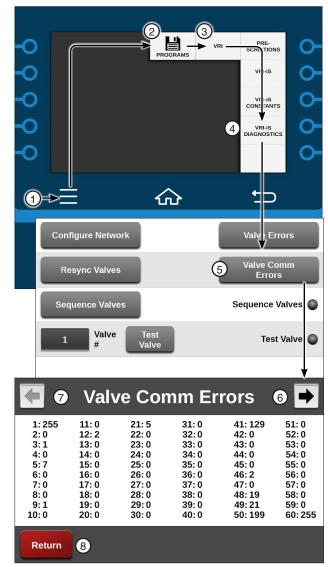
Figure 184-1 1. Menu 5. Valve Comm Errors
